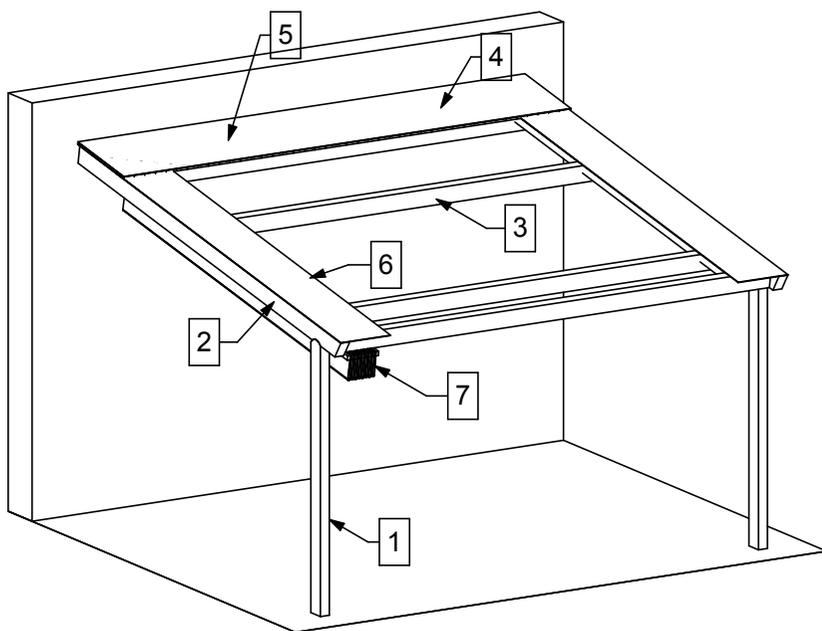
Struttura ombreggiante addossata, con sistema di regolazione pendenza variabile da 0 a 15°
